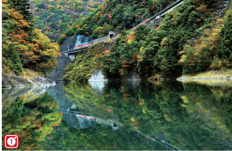
▲急勾配を行く南アルプスあぶとライン 日本で唯一のアプト式の区間で、1.4kmの急勾配の坂を歯車を利用して上り下りします。スイスの山岳鉄道なども活躍する方式です。
